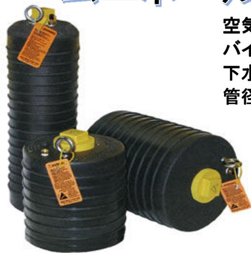
空気圧で膨張させて管内壁に密着します。バイパス付で、水替え工事に使用できます。下水管の水替え、圧力テストに使用します。管径150~525mmに適用するサイズを用意しています。
